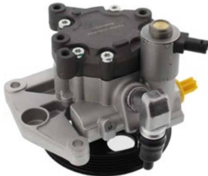
Zur richtigen Positionierung des Anschlusses, bitte die Verschraubung leicht lösen und den elektrischen Anschluss richtig positionieren. Verschraubung mit max. 15 Nm wieder festziehen.
